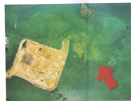
港珠澳大橋人工島海域，工程期間見到明顯由泥沙洩漏做成的「Mud Plume」，海水變得混濁不堪，令海洋生物受害
